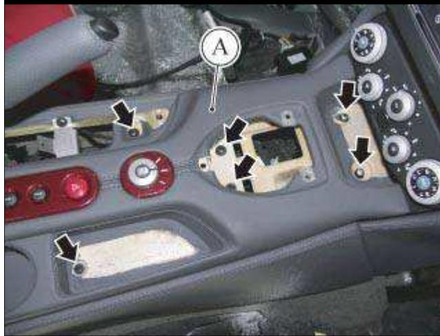
● 手动拧紧紧固上部控制台饰板 (A) 前部的六个螺钉。
