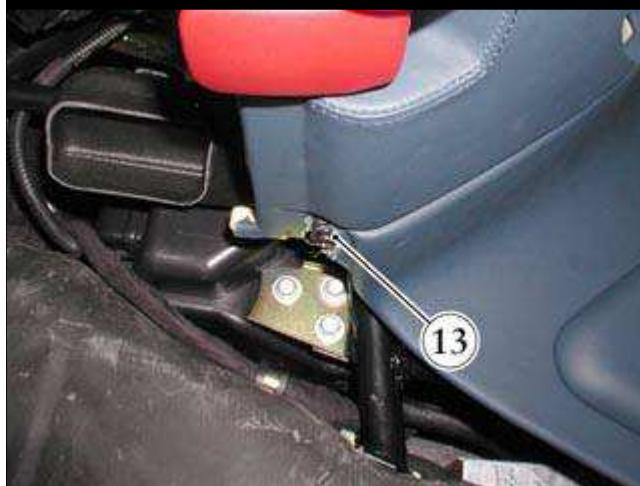
● 拆卸紧固左侧面板底部的螺钉**(13)**。
