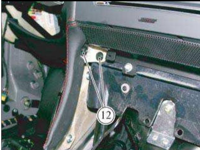
■ 拧紧紧固左侧面板顶部的两个螺钉**(12)**。
