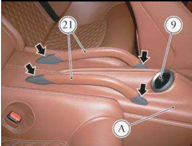
● 从上部控制台饰板 (A) 的后部拆卸后部手柄 (21) (先要松开四个螺钉)。
