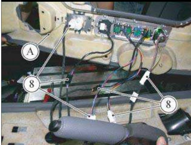
■ 握住上部控制台饰板 (A), 安装 6 个插头 (8) 并将其以正确方式放置到其壳体中。
