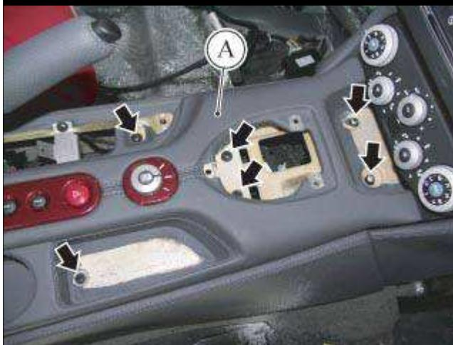
● 松开紧固上部控制台饰板 (A) 前部的六个螺钉，然后将其撬出并提起。
