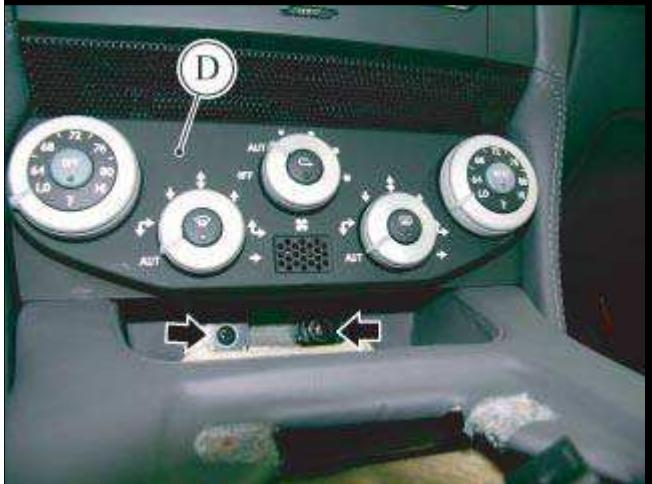
● 定位好空调控制面板(D)并拧紧两个螺钉。
