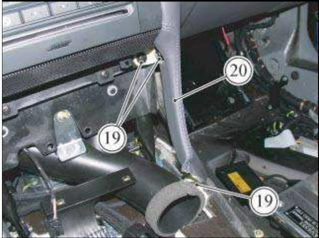
● 安装右侧面板(20)并通过拧紧三个螺钉(19)将其紧固。
