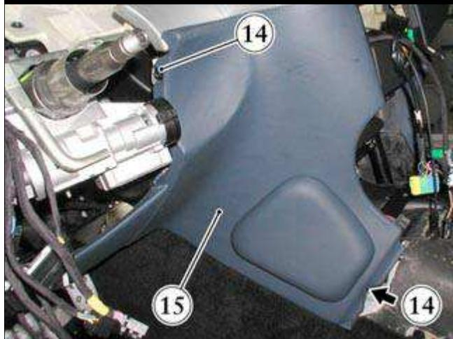
● 安装左侧通道侧面板(15)并通过拧紧两个螺钉(14)紧固。
