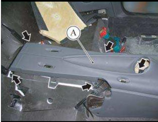
● 松开紧固上部控制台饰板 (A) 后部的 5 个螺钉。
