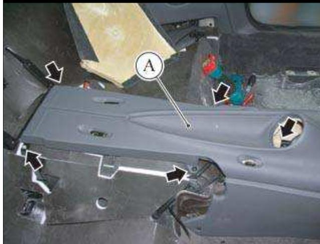
● 手动拧紧紧固上部控制台饰板 (A) 后部的 5 个螺钉。
