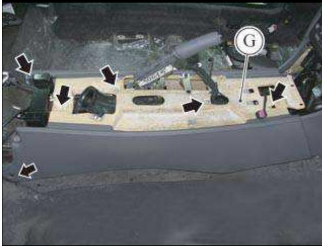
■ 放置下部控制台饰板 (G) 并将其朝向乘客舱前部安装, 使用指示的六个螺钉紧固。
