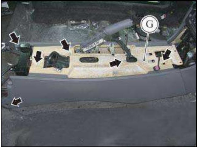
■ 松开紧固下部控制台饰板 (G) 的六个螺钉, 然后将其拆卸 (从乘客舱后部将其拉出)。
