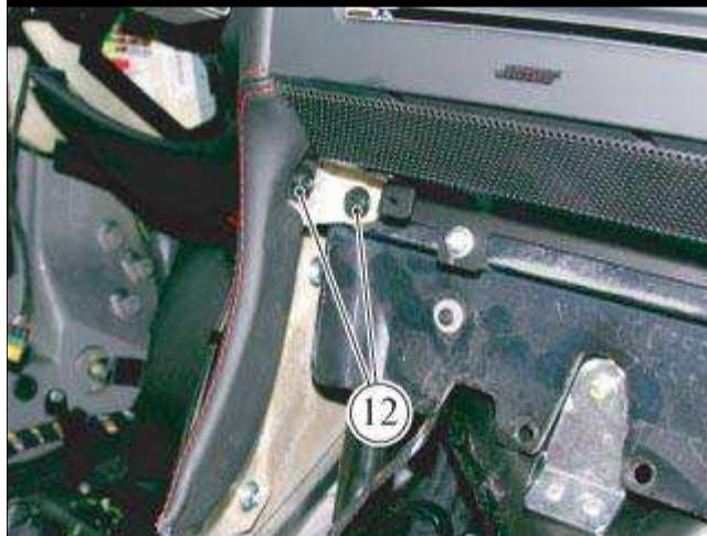
● 拆卸紧固左侧面板顶部的两个螺钉**(12)**。
