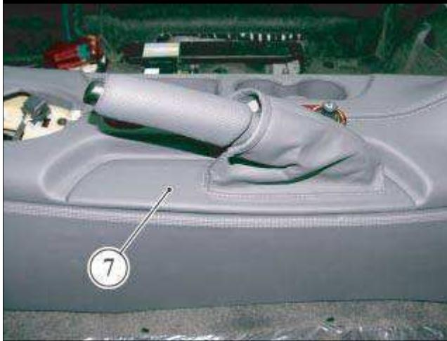
● 松开将波纹防尘罩固定到手制动杆的夹子，将镶边饰条 (7) 从其底座中压出并拆卸。
