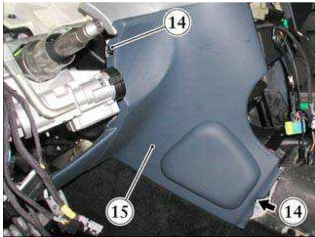
● 松开两个螺钉(14), 然后拆卸左侧面板(15)。
